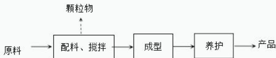
图5-17 工艺流程图
