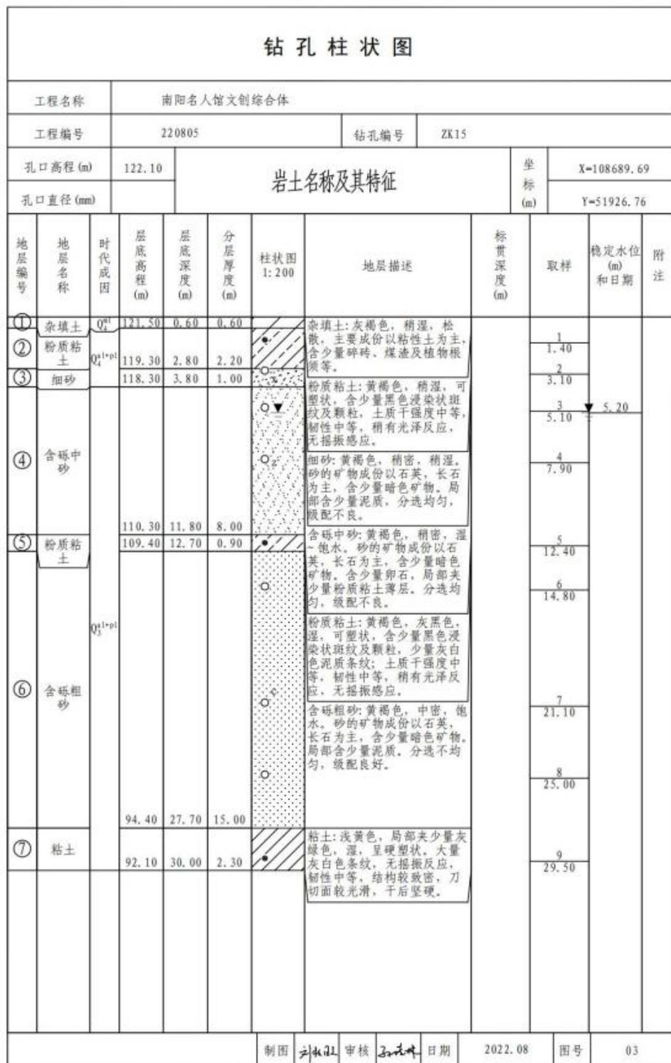
图3-4 钻孔柱状图
