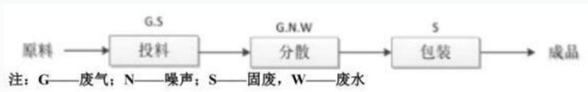
图 5-22 生产工艺及产污环节图
